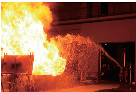
模擬タンク火災泡消火の様子
